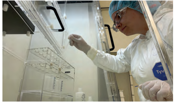
Dr. Sara Kimmig bereitet Ionenaustauscher zur chemischen Reinigung von Kalzium für die Isotopenanalyse vor. (Foto: S. Kimmig, KIT)
