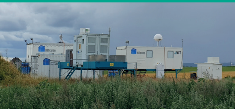
Der KITcube misst Atmosphärendaten bis in fünf Kilometer Höhe. (Foto: Oertel)
