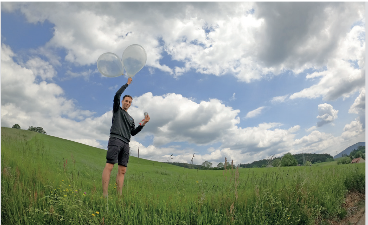
Damit Heliumballons die Messsonden direkt in die Gewitterzelle tragen, sind exakte Wettervorhersagen und ein gutes Gespür nötig. (Foto: Kunz)
