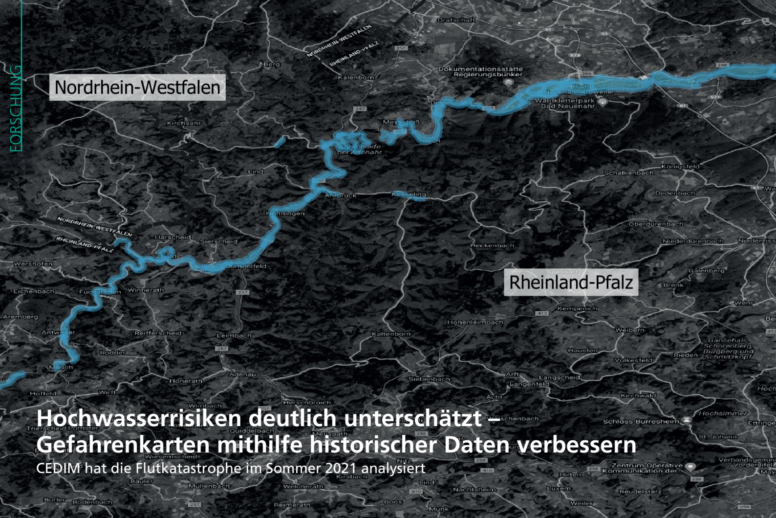
Abschätzung der zu mehr als 75 Prozent überfluteten Fläche entlang der Ahr. (Abbildung: A. Schäfer, CEDIM/GPIKIT)
