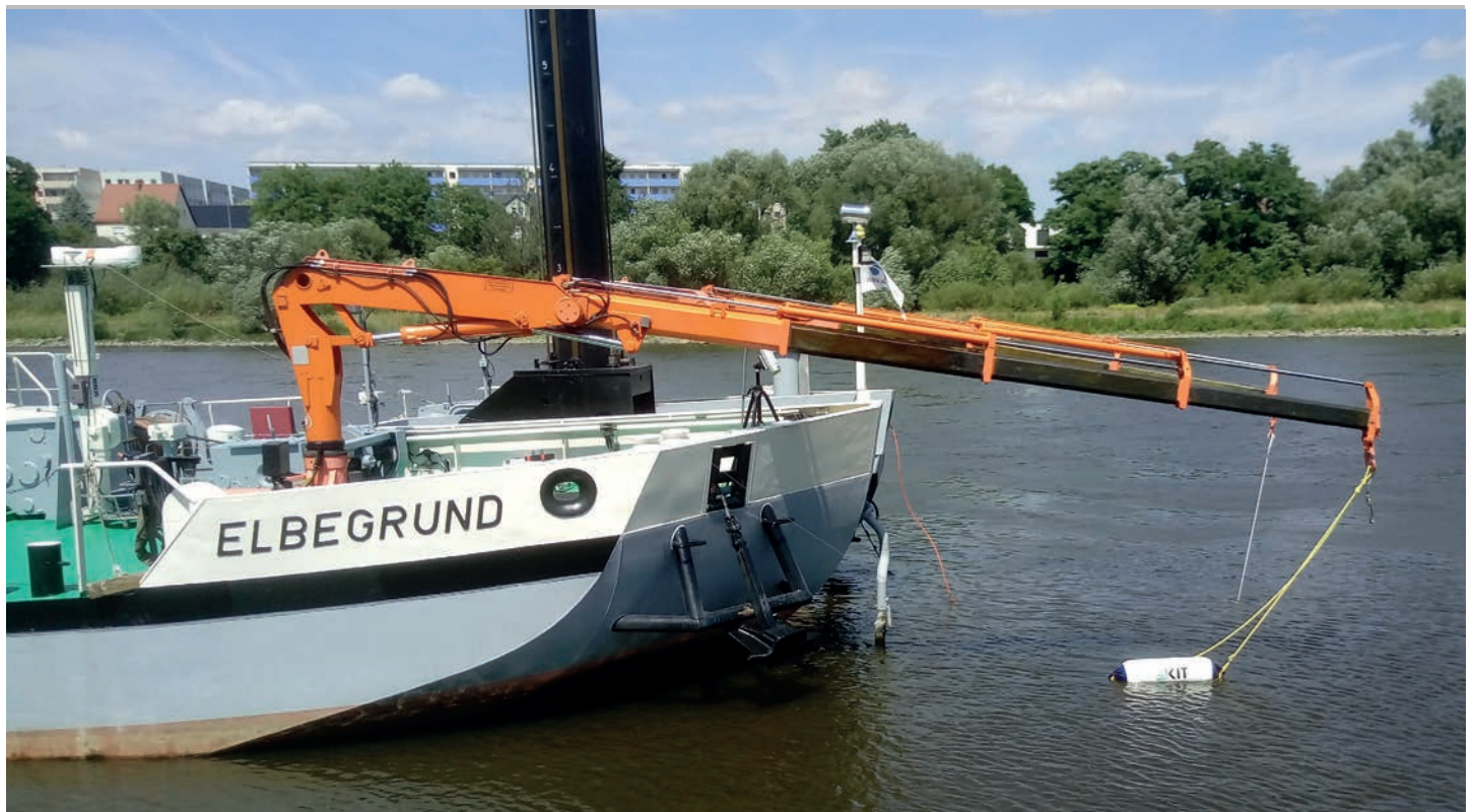
Die Elbe als Real-Labor für Genauigkeitsuntersuchungen hyperspektraler Messmethoden: Messboot mit Hyperspektralsensor und begleitender Probenentnahme. (Foto: Keller, S. et al., Hyperspectral Data and Machine Learning for Estimating CDOM, Chlorophyll a, Diatoms, Green Algae and Turbidity , Int. J. Environ. Res. Public Health 2018, 15(9))
